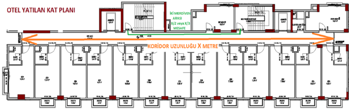
Şekil 8. Otel binası normal katlarda merdiven konumlandırılması
