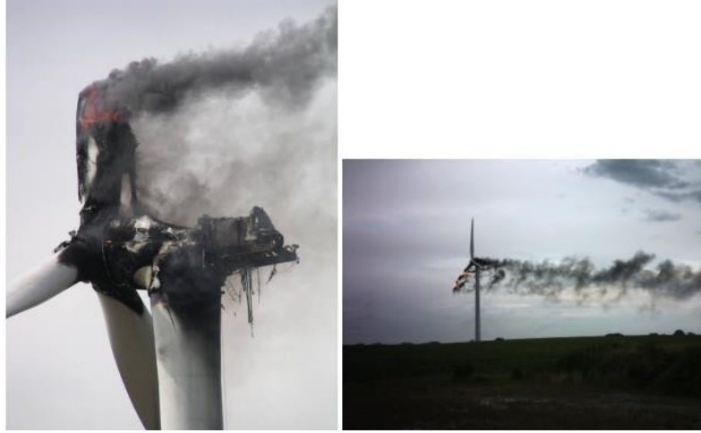
Şekil 7. 2004 yılında 2 MW'lık bir rüzgar türbinine yıldırım düşmesi sonrası çıkan yangın (Resim kaynağı: HDI/Gerling)
