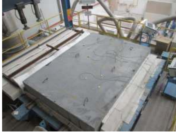
Şekil 7: Efectis Era Laboratuvarı’nda Avrasya Tüneli projesi için gerçekleştirilen beton tabya yangın dayanım (spalling) testi, Nisan 2014
