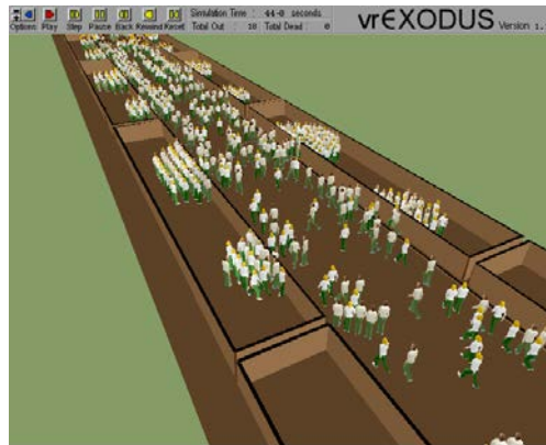
Şekil 4: vrEXODUS [6] ile hazırlanmış örnek kaçış modellemesi çıktısı
